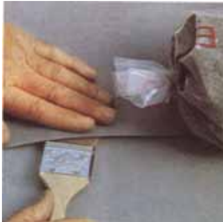
Συγκόλληση με διαλύτη THF
